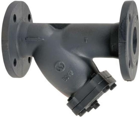
**FILTRE A TAMIS - A bride - Filtre en Y - Corps fonte - Cartouche inox 304 démontable - Pression nominale 16 bar - Température de - 10°C à + 120°C**
