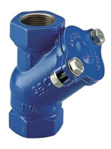
CLAPET DE NON RETOUR SYSTEME D'OBTURATION B - FF - Eaux usées, liquides visqueux, chargés -Corps fonte GJL révêtue époxy extérieur - Boule résine formophénolique - Température 80°C
